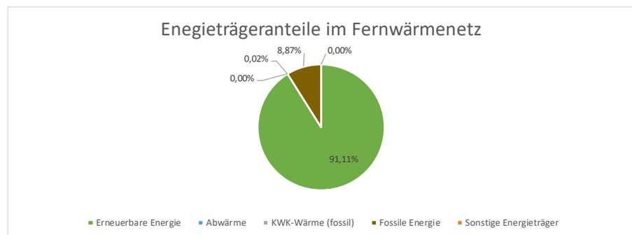
\* Unter dem Begriff „Kraft-Wärme-Kopplung“ (KWK) wird die gleichzeitige Erzeugung thermischer Energie und elektrischer und/oder mechanischer Energie in einem Prozess verstanden. "KWK-Wärme" bezeichnet die in diesem Prozess erzeugte und in ein Fernwärmenetz gelieferte Wärme (z.B. Wärme aus einem mit Erdgas befeuerten Gas- und Dampfkraftwerk oder aus einem Gasmotor).
